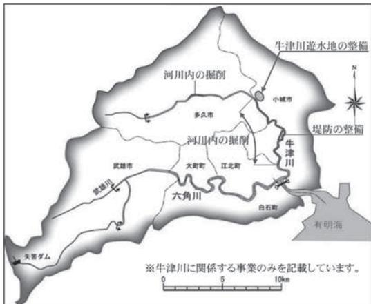
この治水対策を行うことで、令和元年8月洪水と同じ規模の洪水が発生した場合でも、堤防からの越水を防ぎ、安全に洪水を流下させ、排水ポンプの運転調整の回避を図ります。
