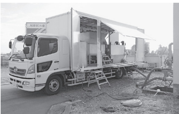
▲汚泥脱水中の移動処理車
