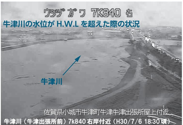
六角川・牛津川は、流域でポンプ排水量約360m<sup>3</sup>/sの排水機場が整備されており、洪水時による河川水位への影響は無視できないものとなっています。このため、河川氾濫による甚大な洪水被害を回避するため、最終的な手段としてやむを得ず実施するものです。六角川流域ではこれまで平成21年7月、平成24年7月および平成30年7月に運転調整を実施してきました。
