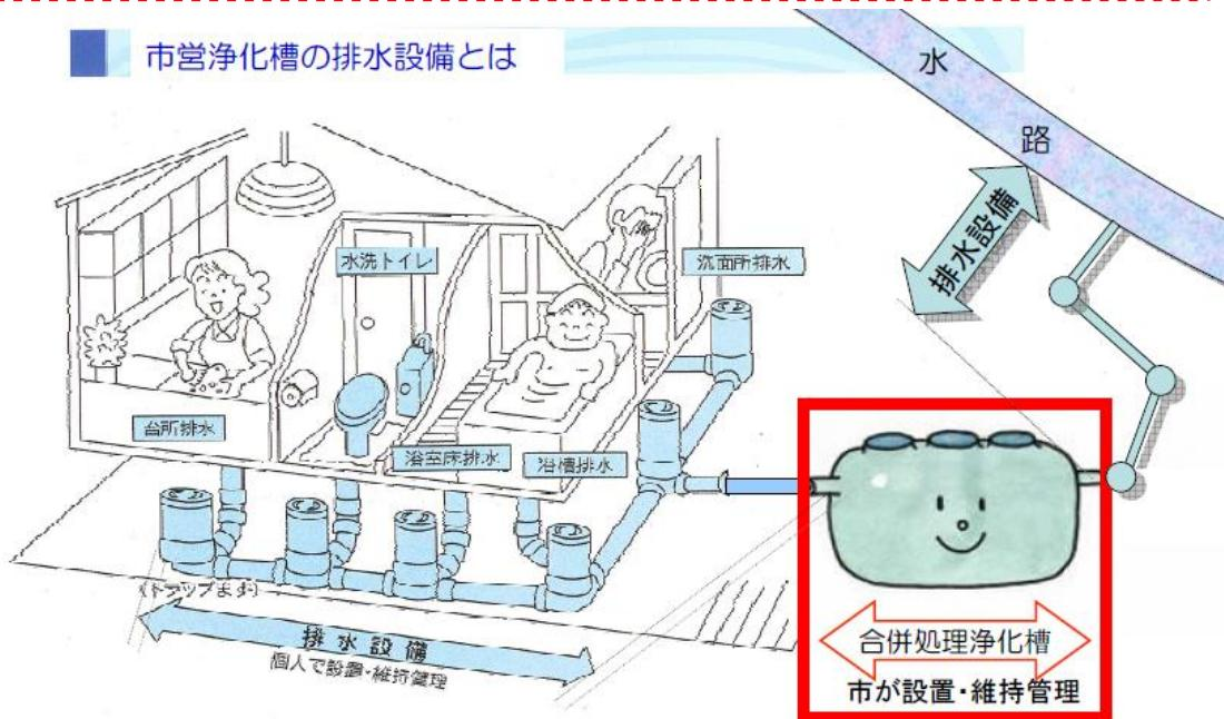
上図の浄化槽に流入し、浄化槽から放流する青色の配管・栓等を合わせて「排水設備」といいます。この部分は申請者の皆様のご負担で設置・維持管理していただきます。
