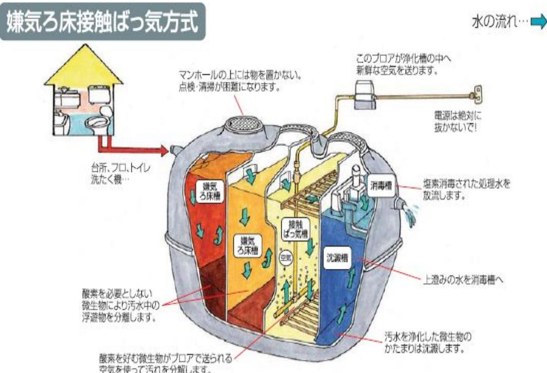
浄化槽は BOD 除去率 90%以上・処理水質は BOD 20 mg/l 以下で、これは公共下水道や農業集落排水処理施設と同程度です。
