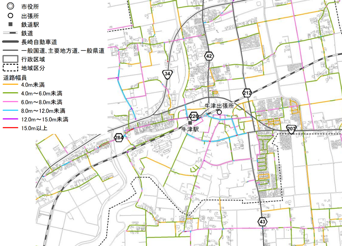
図 道路幅員 拡大図②
