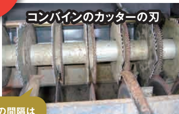
コンバインのカッターの刃 刃の間隔は 15cm
